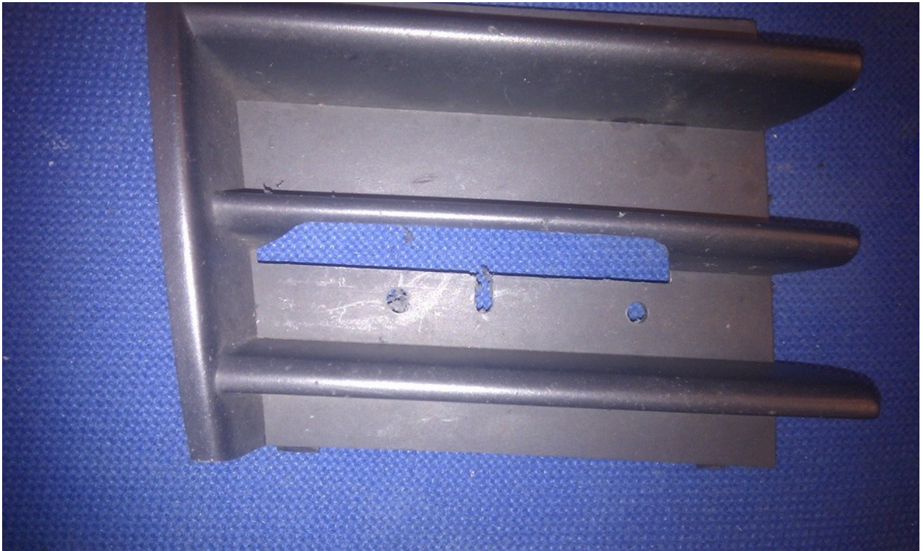
Das Gitter mit den beiden 5mm Löchern und dem Schlitz für das Kabel
