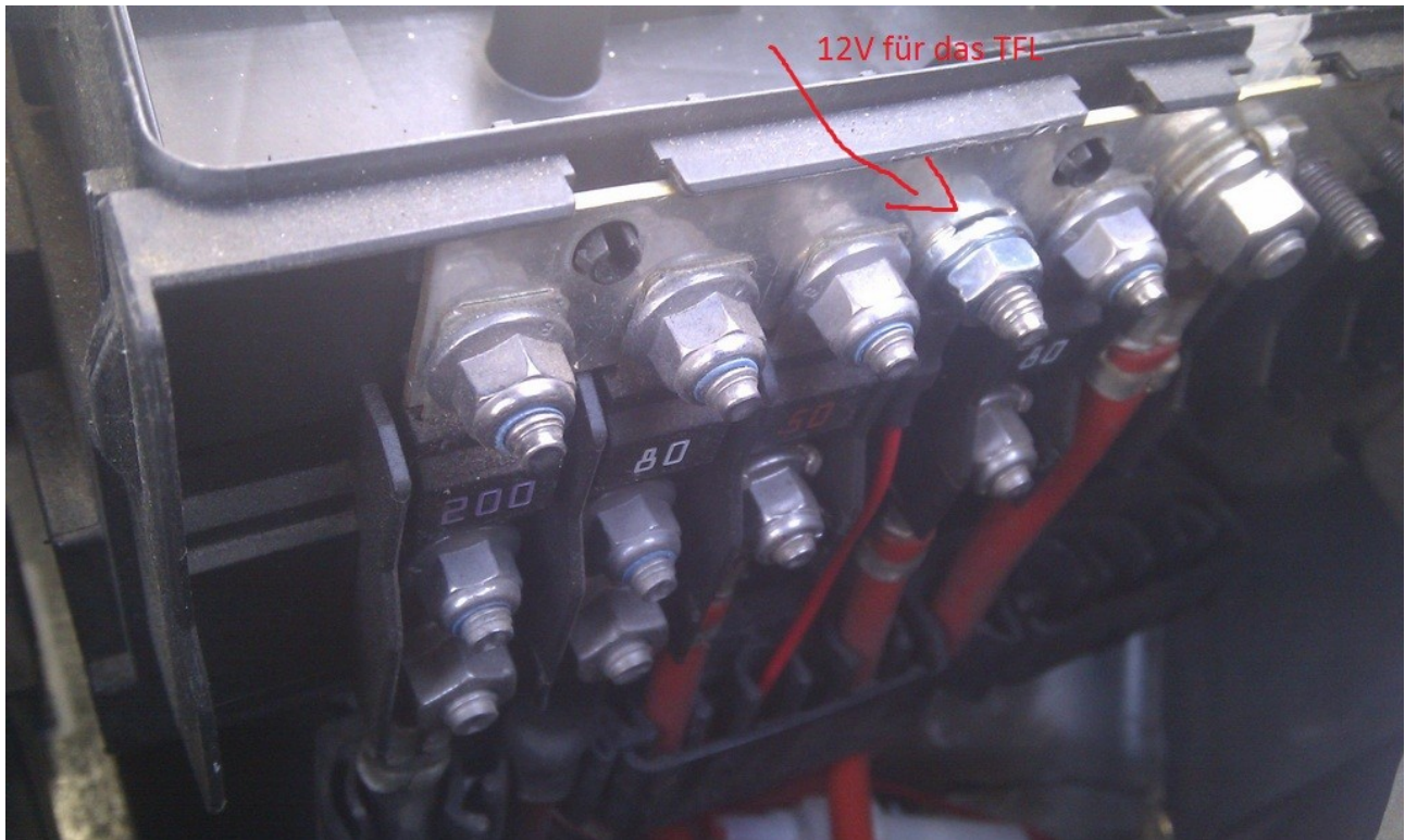
12V Schiene im Sicherungskasten (im Motorraum)
