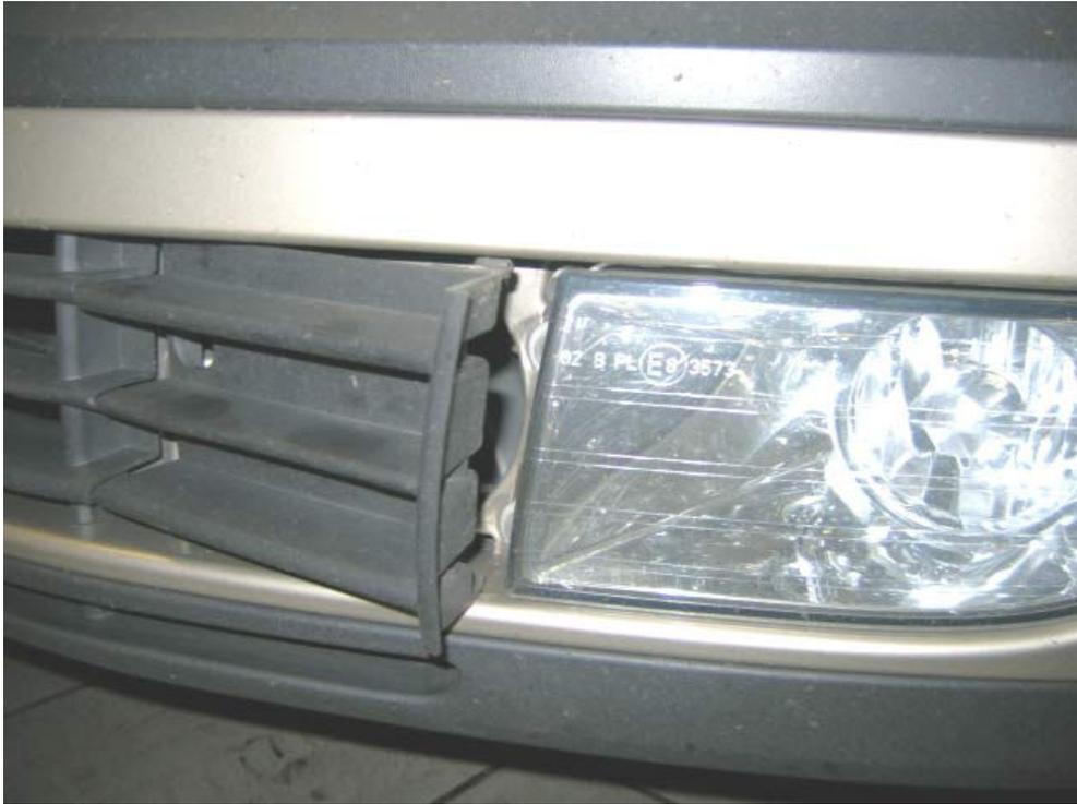
die markierten Schrauben lösen und Scheinwerfergehäuse wieder leicht nach links vorne ziehend entnehmen
