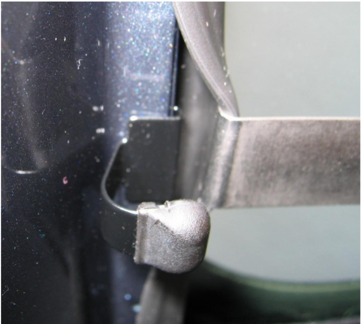
Die 5 Clipse werden wie in der beiliegenden Anleitung beschrieben auf dem Fensterrahmen verteilt.
