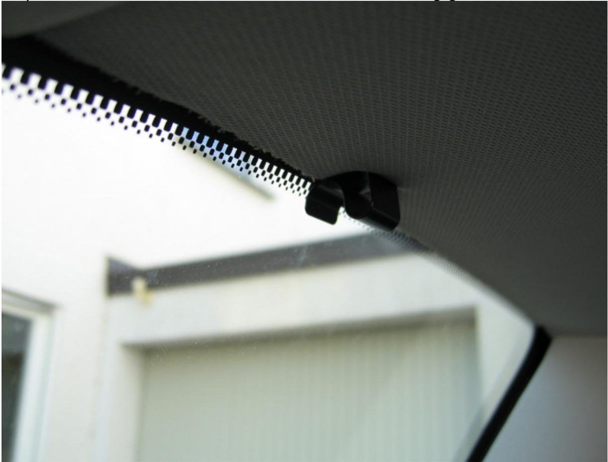
Der Sonnenschutz wird unten an der Scheibe eingesetzt und oben durch Herunterdrücken des Rahmens in den Clip eingerastet. Fertig.
