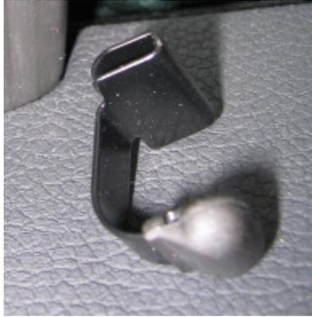
Nachdem man mit dem beiliegenden Haken das Gummi des Fensterrahmens etwas zur Seite gezogen hat, lässt sich der Clip ganz einfach auf den Fensterrahmen schieben.
