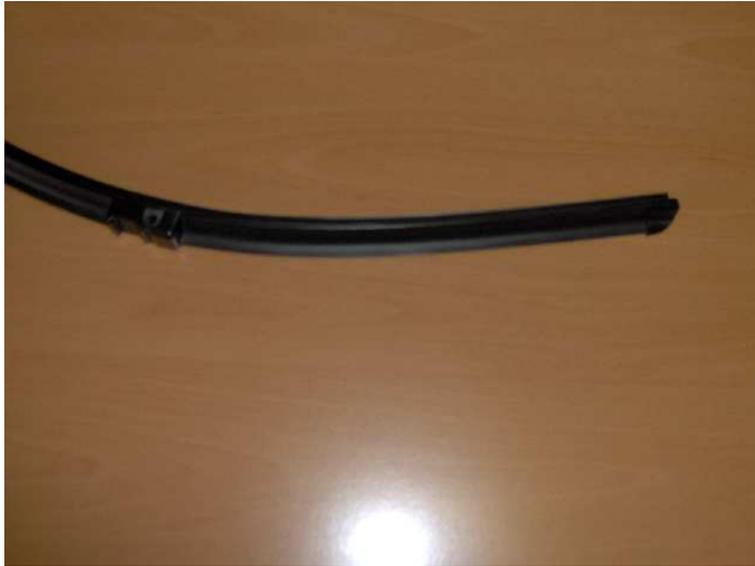
Mit einer Flachzange zieht man die Kappe ab. Dazu ist etwas Kraft notwendig – die Kappe sitzt sehr fest. Der weiche Kunststoff leidet etwas, d. h. man sieht hinterher Spuren der Zange. Die Kappe ist aber so robust, dass sie nicht so schnell bricht.
