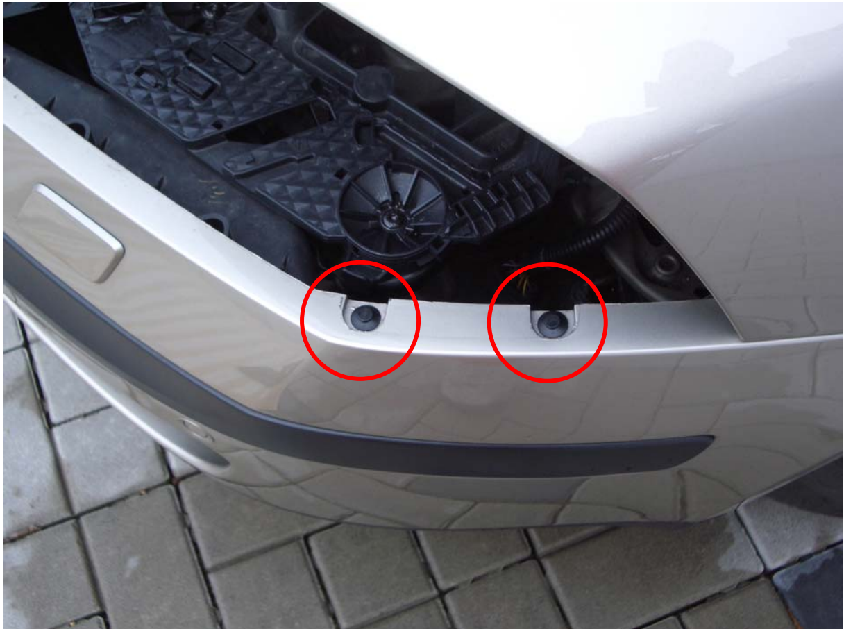
Abbildung 4 Spreizdorne unterhalb der Scheinwerfer (Scheinwerfer demontiert)
