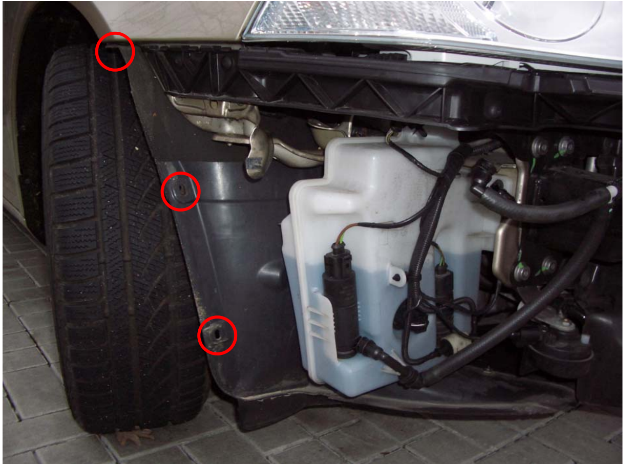
Abbildung 3 Verschraubung im Radkasten
