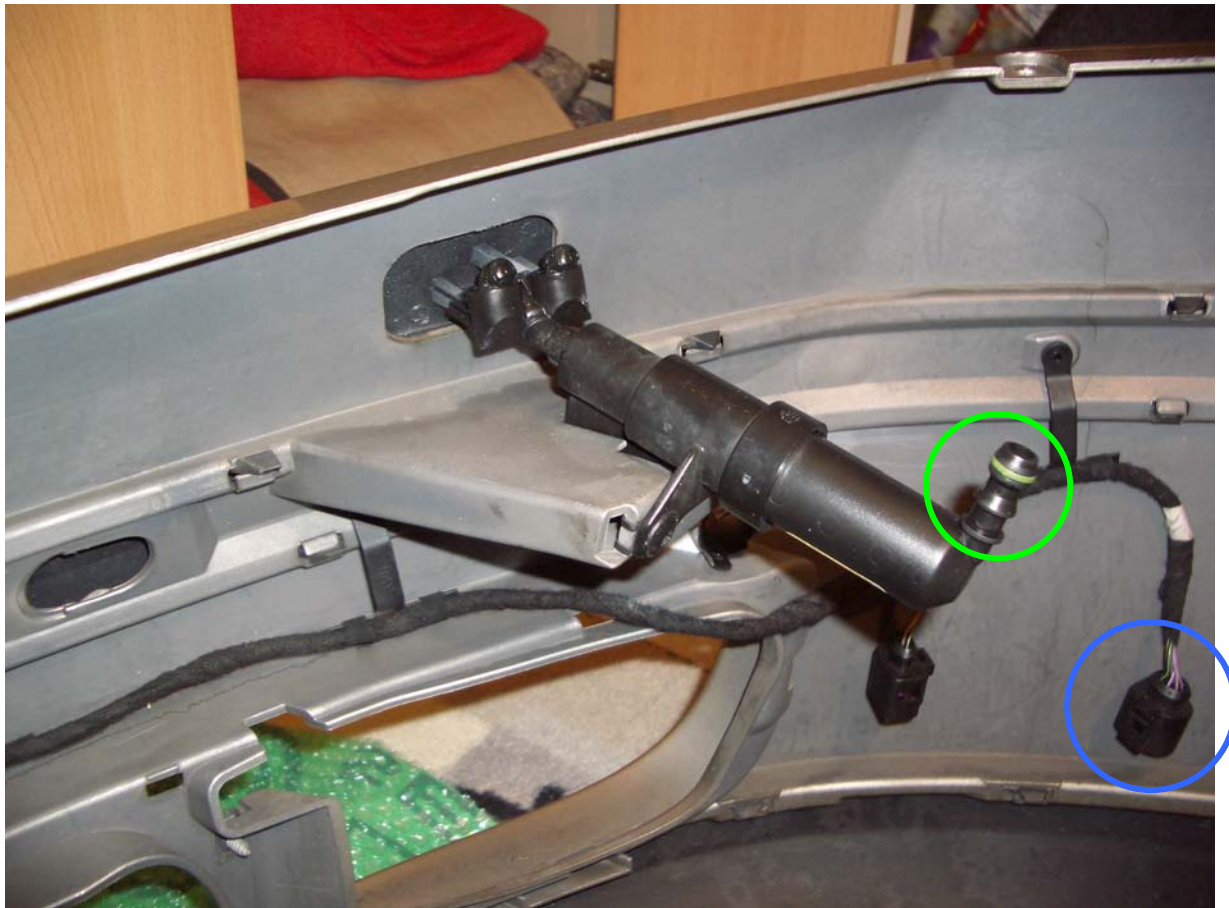
Abbildung 7 PDC (blau) und Scheinwerferreinigungsanlage (grün)
