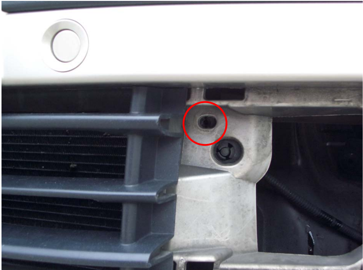
Abbildung 2 Versteckte Verschraubungen unterhalb der Verkleidungen für die Nebelscheinwerfer
