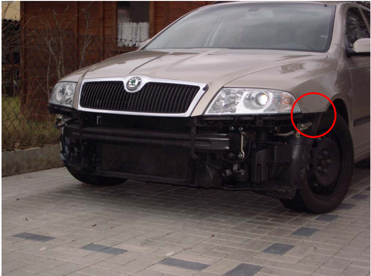
Abbildung 6 Seitliche Einrastpunkte Frontstoßstange
