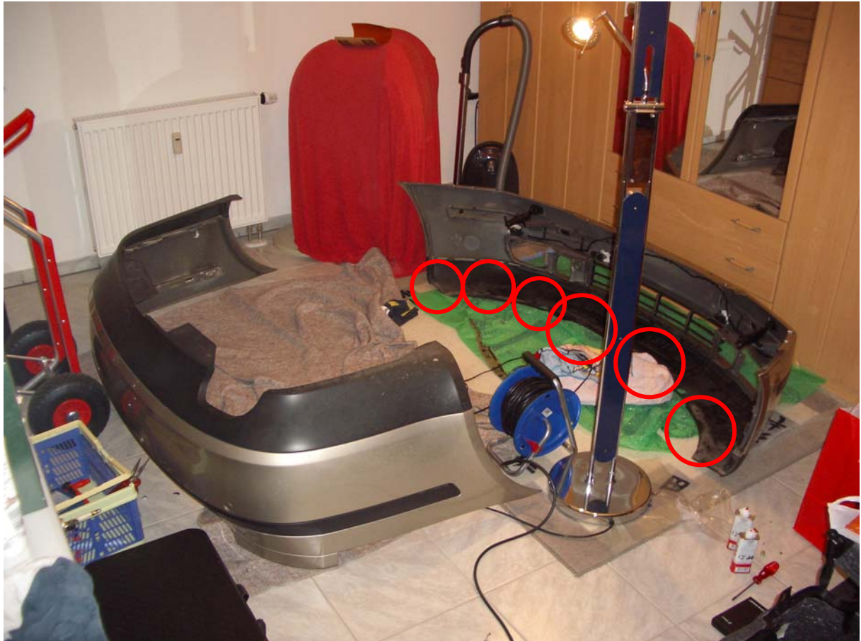
Abbildung 1 Untere Verschraubungen Stoßstange
