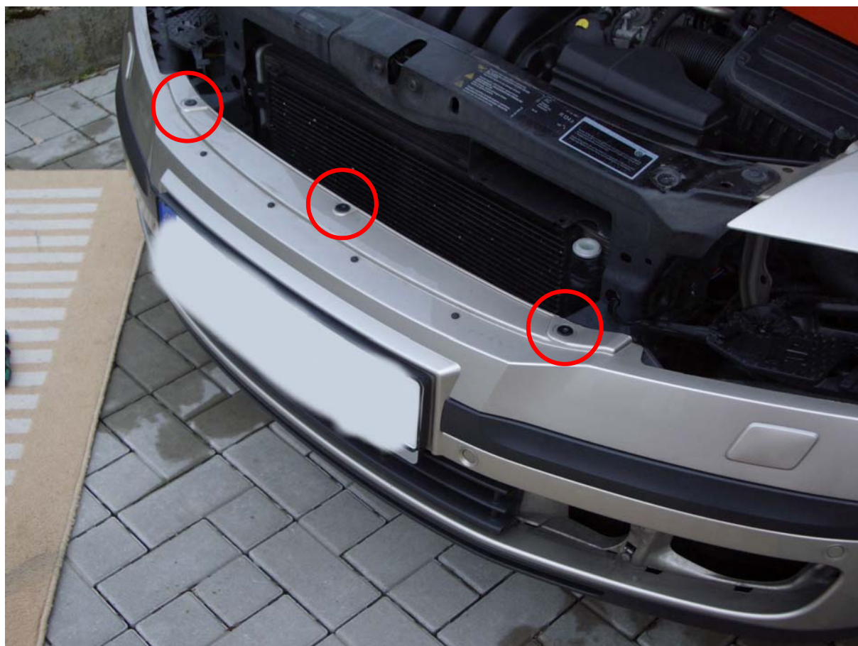
Abbildung 5 Verschraubungen Frontstoßstange Oberkannte
