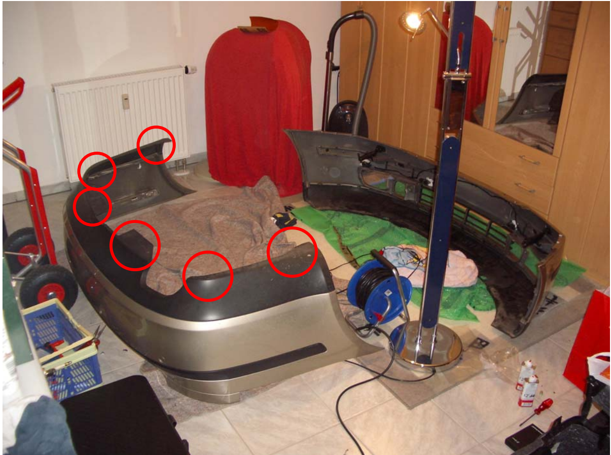
Abbildung 1 Untere Verschraubungen Stoßstange
