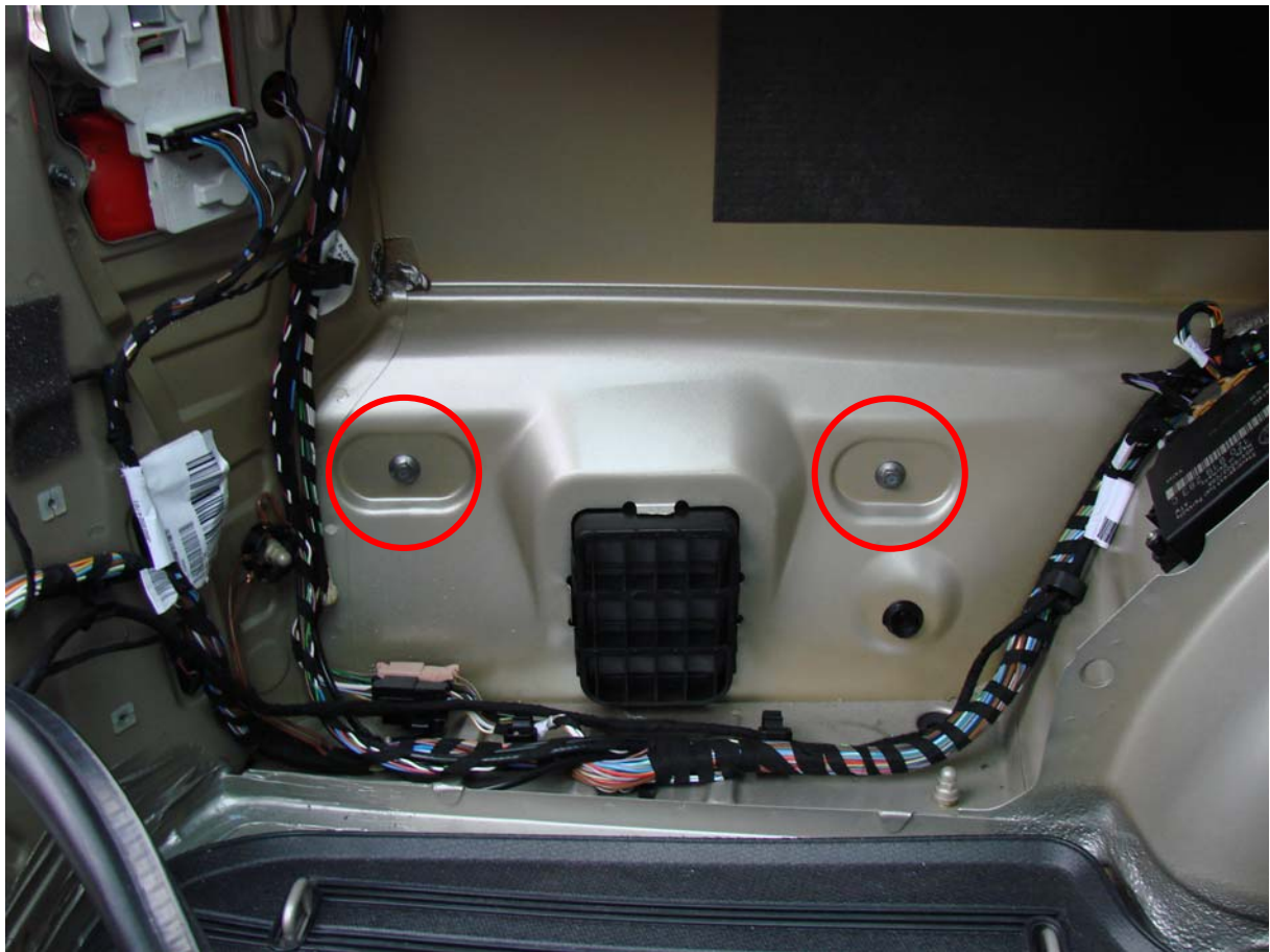
Abbildung 4 Verschraubungen innerhalb des Kofferraumes
