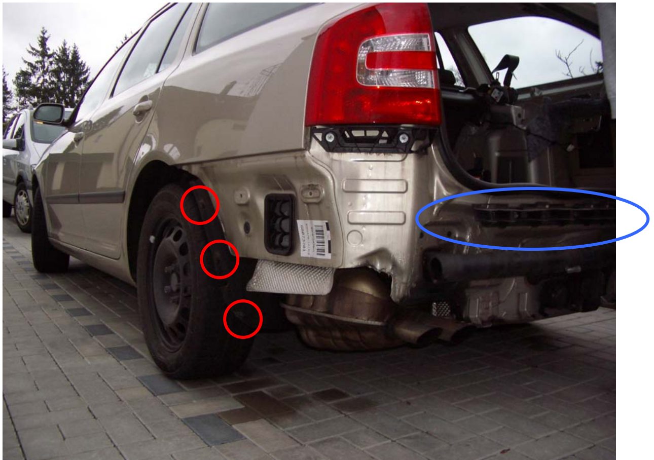
Abbildung 2 Verschraubung im Radkasten (nur rote Markierungen!)
