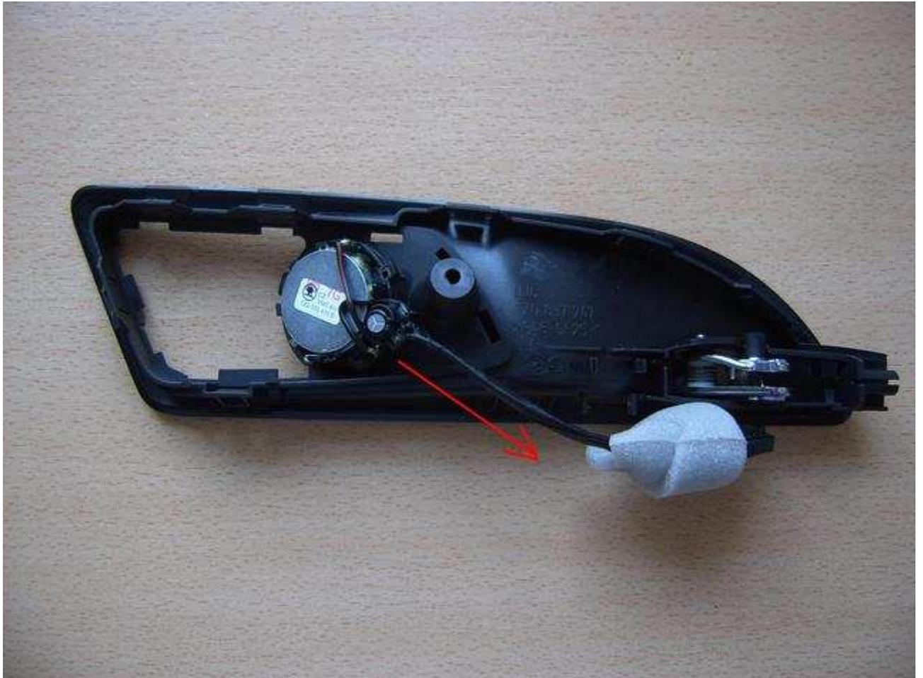
Um den neuen Hochtöner zu befestigen am besten am **rot markierten Bereich** Sekundenkleber auftragen und den Hochtöner befestigen. Er kann auch mit einer Heißklebepistole angeklebt werden. Wobei beide Klebmethoden fest verbinden und dennoch wieder entfernbar sind (bereits getestet), falls was geändert werden soll.
