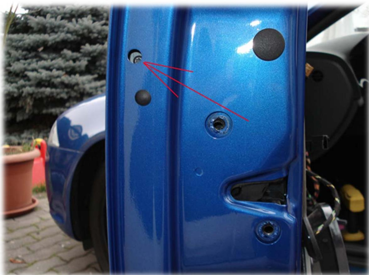
Nun den Schließzylinder mit Hilfe des Schlüssels herausziehen, möglich das ihr vorher die Abdeckung entfernen müsst, geht sehr gut mit einem Cuttermesser welches stumpf ist um nicht in die Abdeckung zu schneiden. Nun muss der Türgriff ausgeclipst werden, das geht auch wieder sehr gut mit einem Cuttermesser
