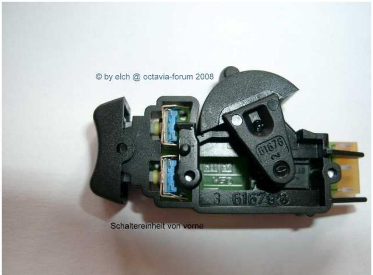
3. TORX-Schrauben auf der Rückseite lösen und Leiterplatte vorsichtig – damit nichts raus fällt - nach oben abnehmen und umdrehen.
