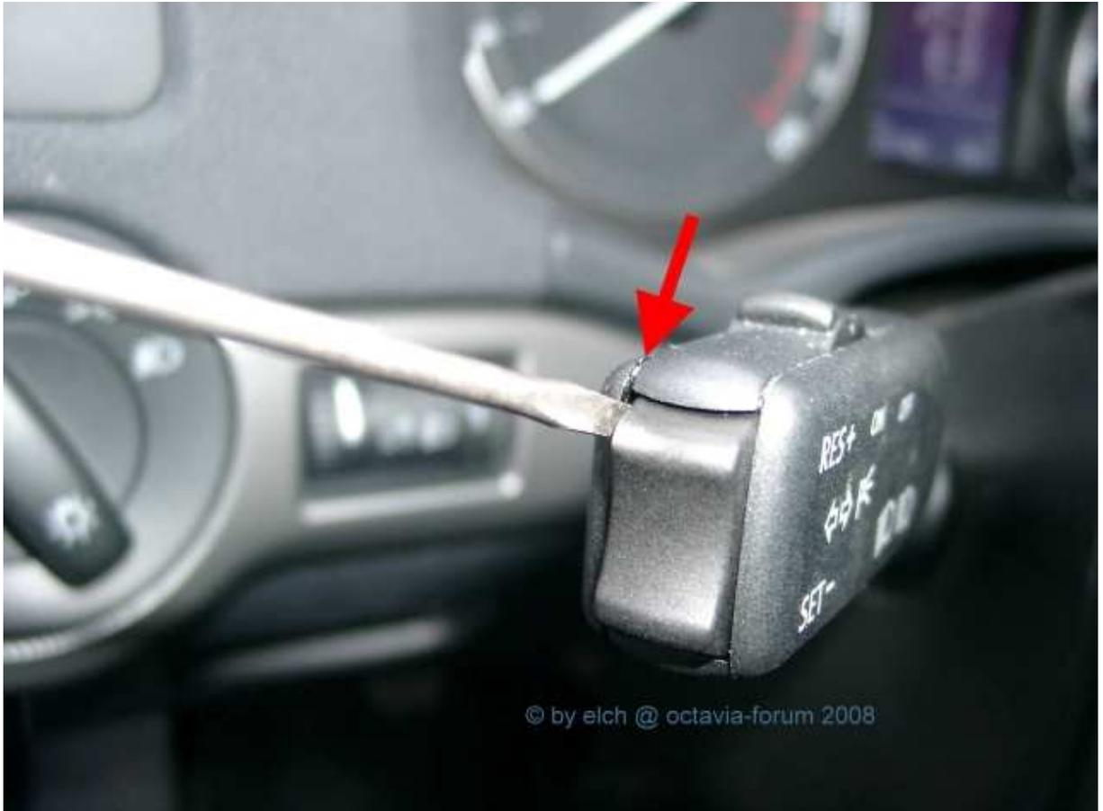
Das Gehäuse schnippst dann auf. Das gleiche am Ein-/Ausshalter (Schiebeschalter der GRA)
