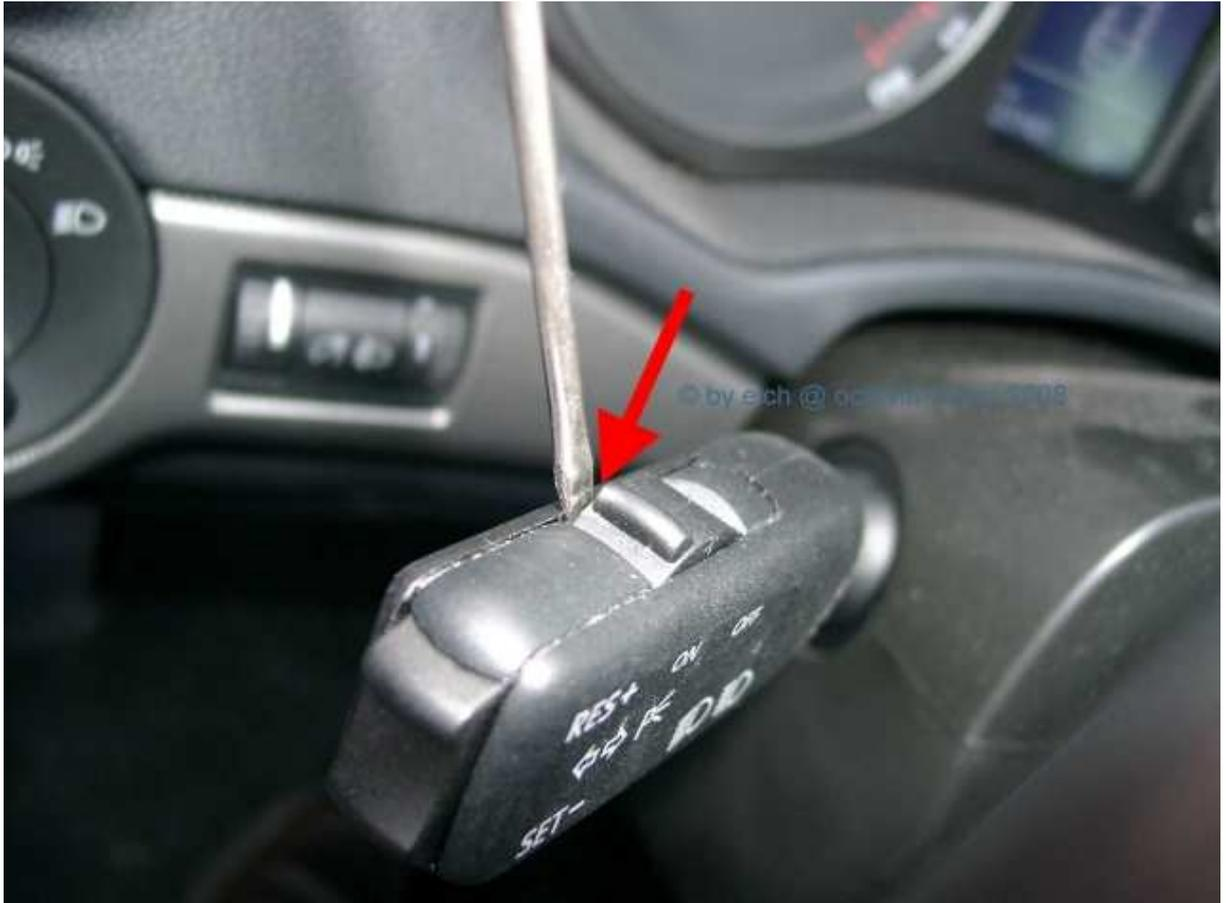
2. Die Schaltereinheit kann man dann rausangeln und von der Steckverbindung abziehen.
