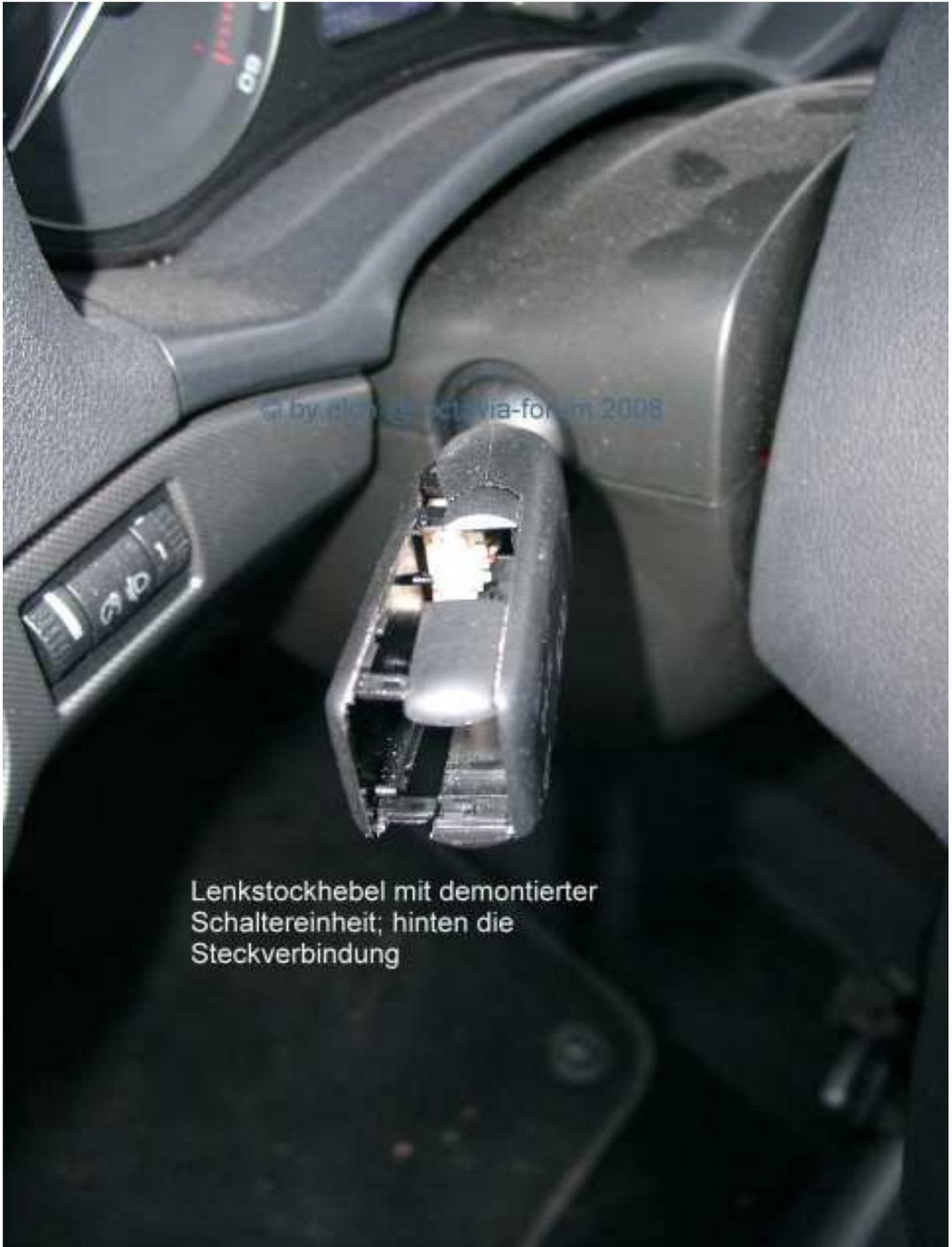
Lenkstockhebel mit demontierter
