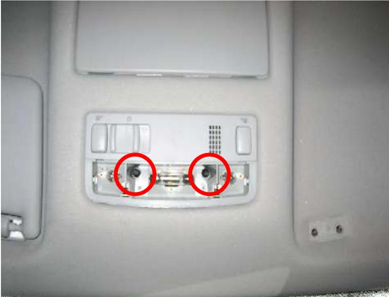
Die darunter befindlichen Kreuzschlitz-Schrauben entfernen
