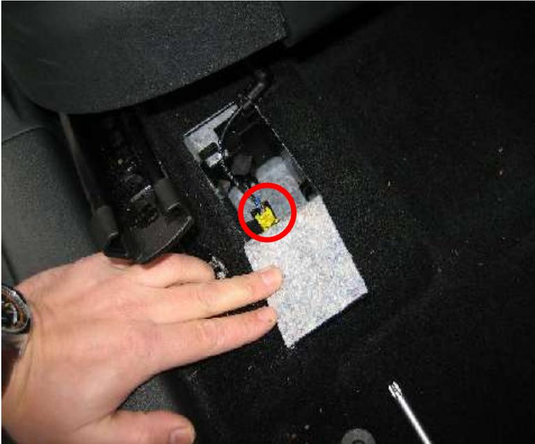
Jetzt den Stecker der Sitzverkabelung lösen. Hierzu den Stecker nach oben aus der Halterung ziehen. Hierdurch wird der gesamte Stecker gelöst. Dann am Gelben Stecker den schwarzen Verschluss zurückziehen und die Steckverbund lösen.
