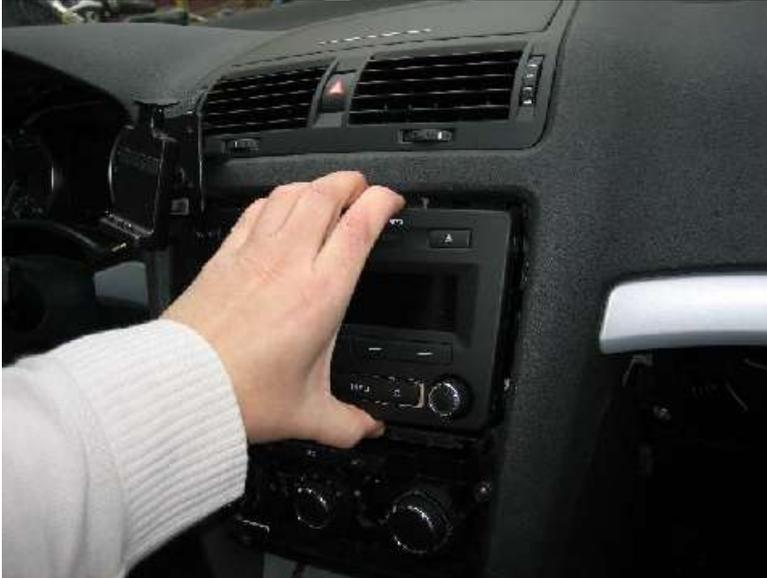
Anschließend die Blende auf dem Radio durch einen leichten Zug entfernen.
