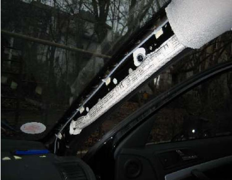
Das Mikrofonkabel an der A-Säule entlang nach oben führen und fixieren (z.B. mit Klebefestigungen und Kabelbinder).
