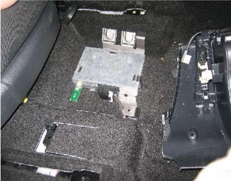
Den Halter verschrauben und das Steuergerät einsetzen. Anschließend die Antenne und den Stecker verbinden.
