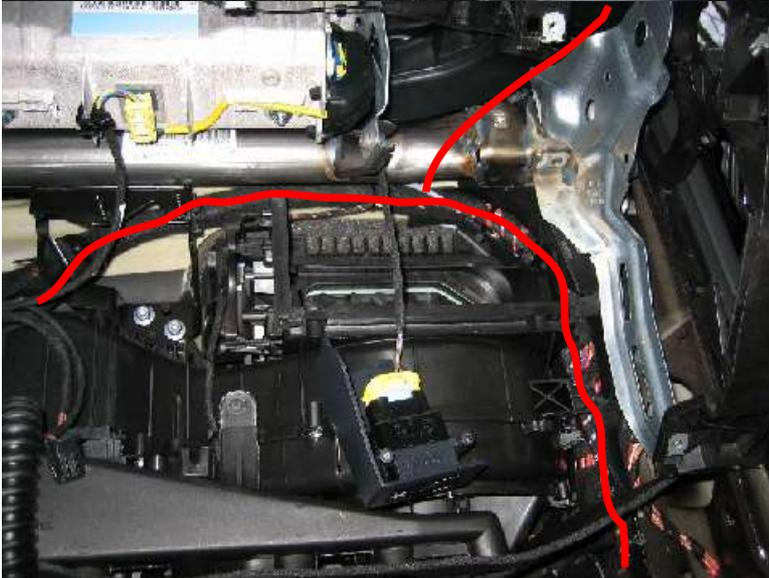
.. und weiter an einem vorhandenen Kabelbaum entlang. Das Mikrofon Kabel (grau) nach oben abzweigen und an der rechten A-Säule ausfädeln. Der restliche Kabelbaum nach unten weiterführen ...
