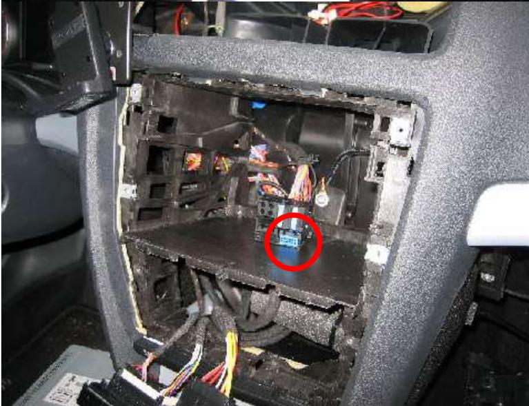
Den blauen Stecker aus dem Original Quadlock-Stecker lösen (Verriegelung hinten). Die mit dem blauen Stecker verbundenen Leitungen aus dem Kabelbaum ca. 5 cm lösen und den blauen Stecker in den Quadlock-Stecker des Plug n Play Kabels einsetzen. Quadlock-Stecker des Original Kabelbaums mit Buchse des Plug n Play Kabels verbinden.
