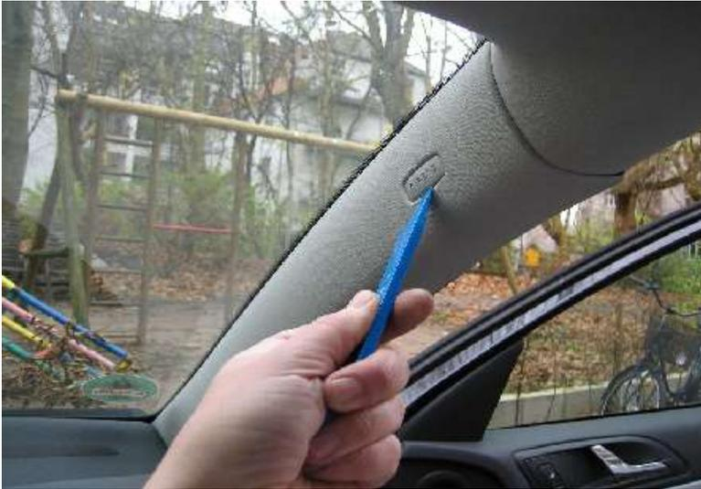
Nun wir die Verkleidung der A-Säule abgenommen. Unter dem Airbag-Schild befindet sich eine Schraube. Diese muss gelöst werden. Anschließend kann die Verkleidung durch ziehen in Richtung Fahrerseite gelöst werden.
