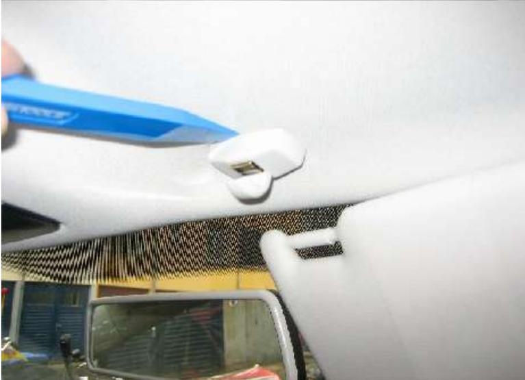
Zu mindestens die linke Befestigung der Sonnenblende sollte entfernt werden um das Mikrofonkabel besser durchfädeln zu können. Zunächst die Sonnenblende ausklipsen, dann mit dem Kunststoffkeil die Abdeckung entfernen. Hierunter befinden sich zwei Schrauben. Diese entfernen.
