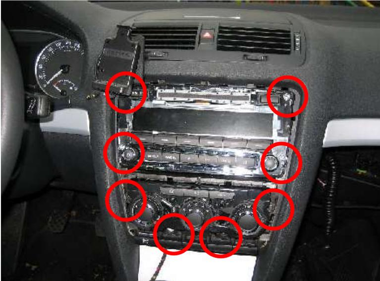
Die markierten Schrauben lösen (TX 20) und das Radio und das Bedienfeld der Climatic entfernen. Kabel am Climatic Bedienteil können verbunden bleiben.
