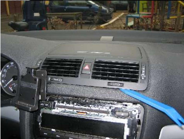
Um die Stecker vom Radio besser lösen zu können ab besten auch noch das obere Ablagefach entfernen. Hier ebenfalls von unten anfangen und das Fach vorsichtig ausheben und nach oben abklappen.
