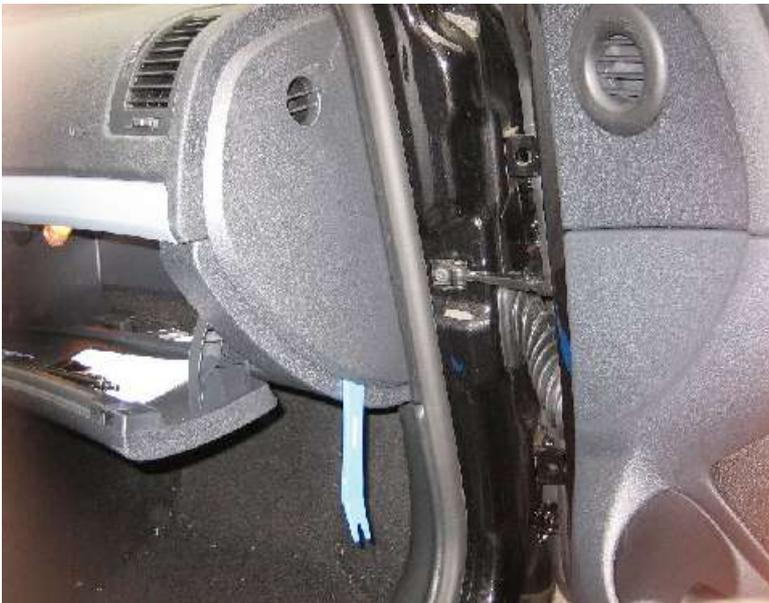
Zum lösen der letzten verbliebenen Befestigung muss zunächst die Seitenklappe des Armaturenbrettes abgenommen werden. Dies geht am einfachsten mit einem Kunststoffkeil.
