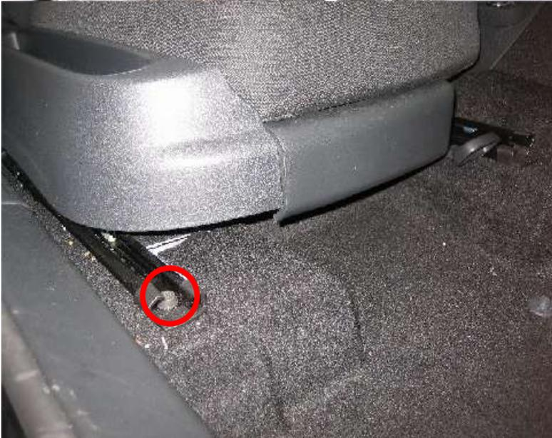
Dann den Sitz ganz nach hinten schieben und die beiden vorderen Schrauben ebenfalls lösen.
