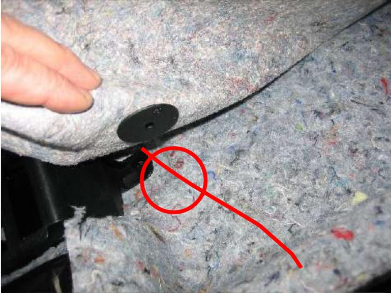
... und unter dem Bodenteppich bis zur markierten Stelle. Hier dem unteren Teppich einschneiden und das Kabel durch das Loch ziehen. Das Kabel neben der Bodenschiene aus der vorhandenen Öffnung raus führen.
