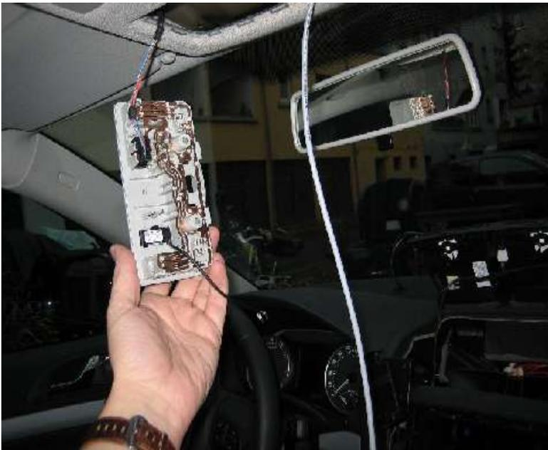
Das Kabel aus der Öffnung der Leuchte herausführen. Das Mikrofon einsetzen und beides miteinander verbinden. Bei mir passten die Stecker nicht aneinander weil es sich nicht um das Original-Mikro sondern von einem Passat handelte. Daher habe ich Stecker und Buchse ersetzt.
