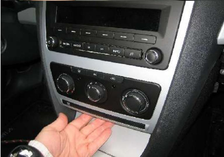
Jetzt die Verkleidung um Radio und Klimaanlage lösen. Hierfür v mit der Hand durch einen leichten Ruck die silberne Verkleidung im unteren Bereich lösen.
