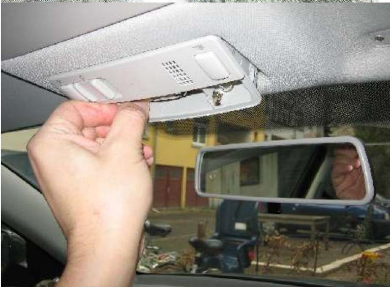
Und die Leuchte durch die dargestellte Kippbewegung mit einem leichten Ruck lösen. Das Lösen der Verkabelung der Lampe ist nicht notwendig.
