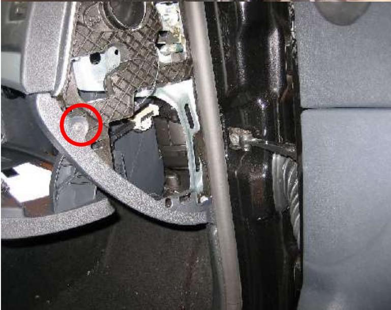
Nachdem die Abdeckung entfernt wurde ist die zu lösende Schraube leicht zu erkennen.
