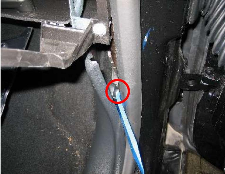
Jetzt wird die Verkleidung des Schwellers auf der Beifahrerseite vorgenommen. Hierfür die Verkleidung wie abgebildet etwas zurückziehen und die weißen Stifte (2x) vorsichtig unter Zuhilfenahme des Kunststoffkeils oder eines flachen Schraubendrehers lösen. Anschließend die Verkleidung langsam nach oben wegziehen. Die Verkleidung ist an der Verkleidung der B-Säule eingehakt. Bei mir konnte ich diese Verbindung durch hochziehen der B-Säulen Verkleidung lösen.
