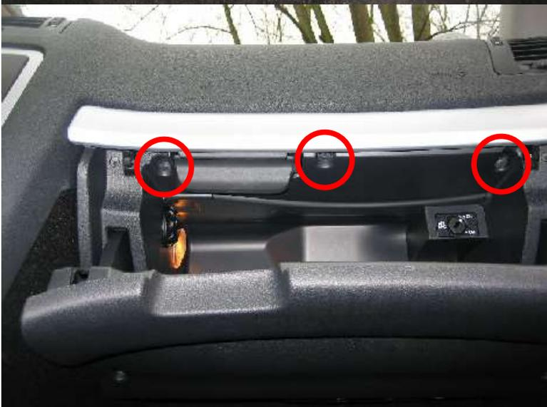
Weitere drei Schrauben im Handschuhfach lösen. Hierfür ist ein kurzer Schraubendreher oder ein Torx-Schlüssel notwendig.
