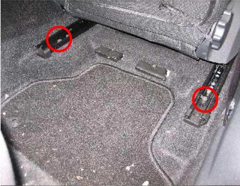
Zunächst die Befestigung des Beifahrersitzes lösen. Hier zu den Sitz ganz nach vorne schieben und die zwei markierten Schrauben mit einem Torx-Schraubendreher lösen.
