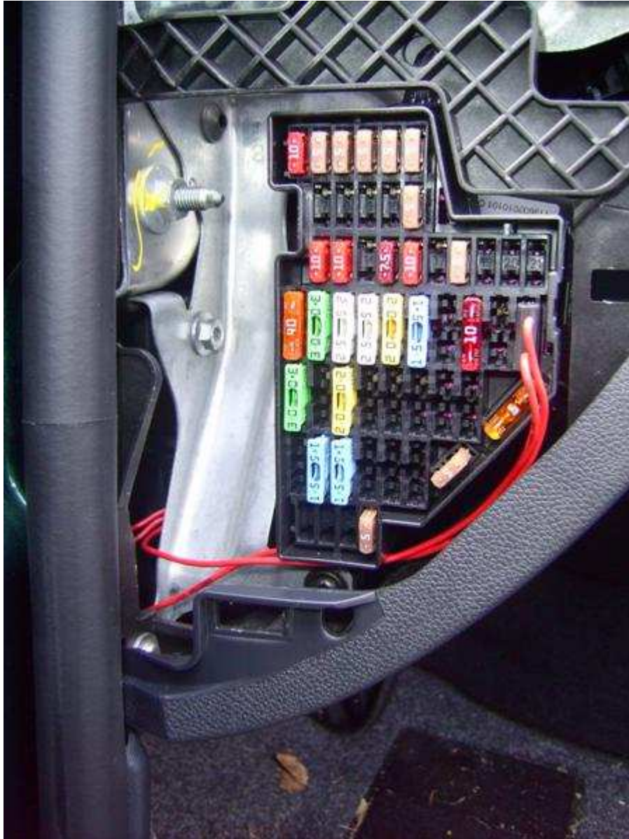
Bild 4: Sicherungskasten mit Zündplusadapter in Steckplatz 31
