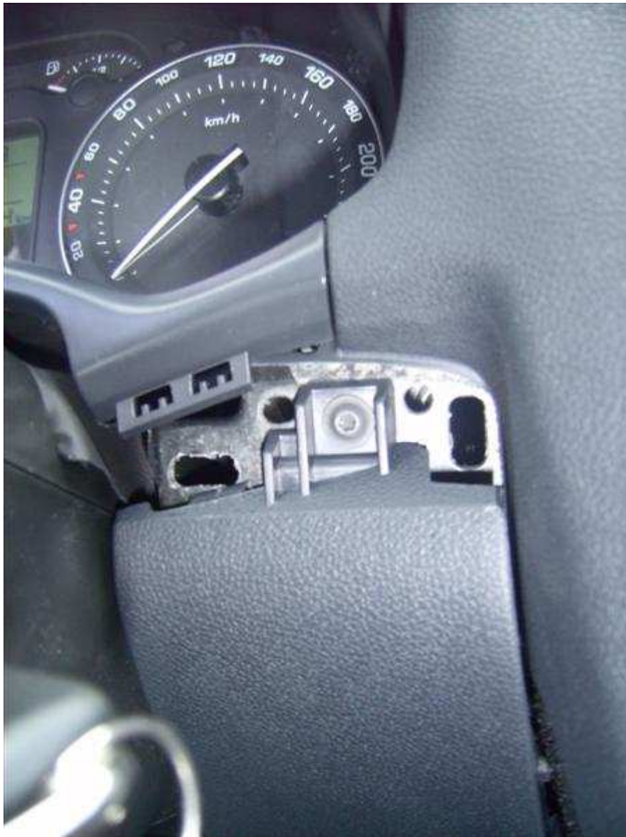
Bild 6: Ausbau Armaturenverkleidung
