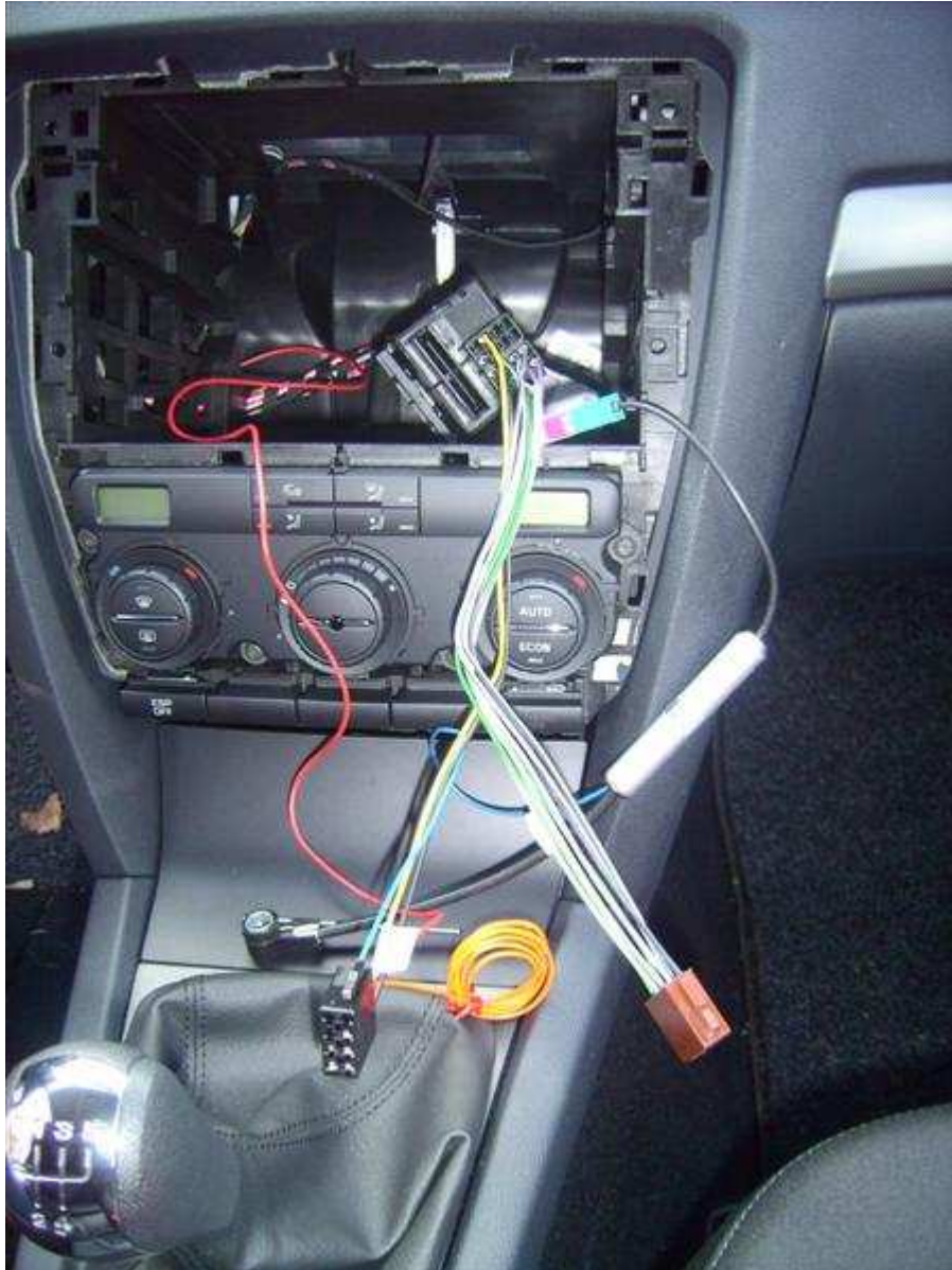
Bild 11: fertig „verkabelter“ Quadlockadapter
