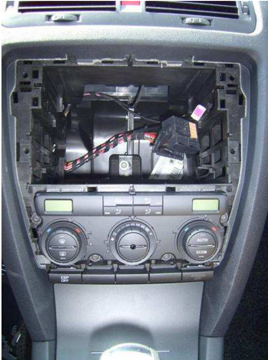
Bild 9: Ausbau Armaturenblende
