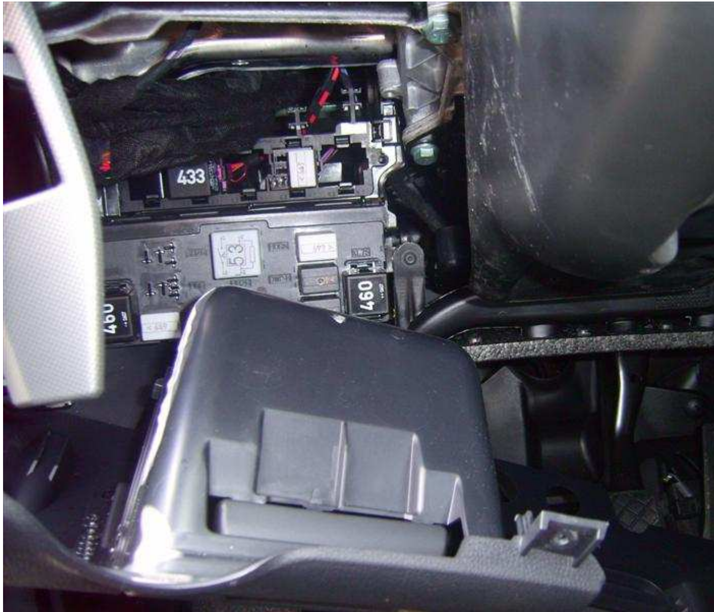
Bild 5: Ausbau Armaturenverkleidung
