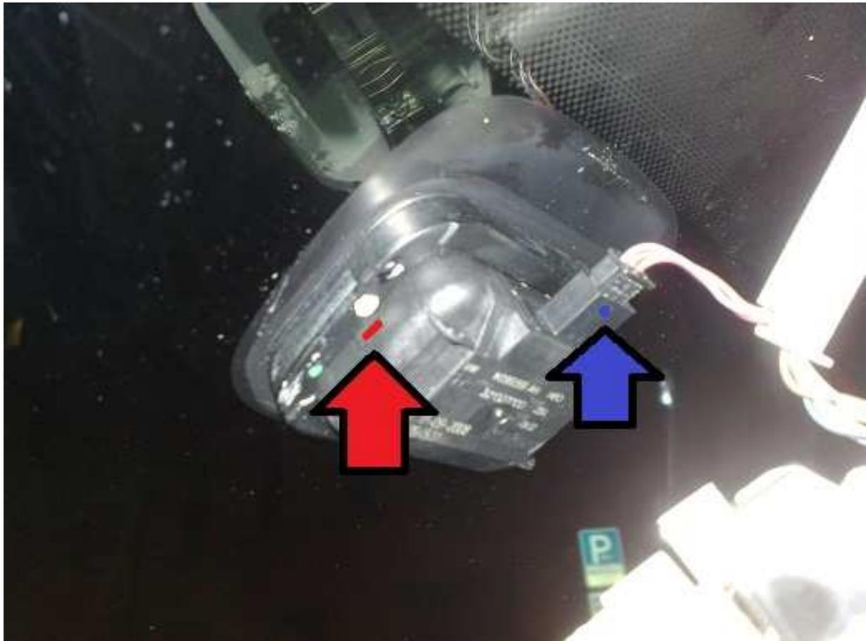
Neuen Sensor rein -ganz ohne kleben o.ä.- und anschließend alles in Umgekehrter Reihenfolge wieder zusammen bauen, kurz testen und freuen.. Wenn man den Rückspiegel wieder auf die Halterung schiebt, muss man wirklich bis zum Anschlag schieben, es rastet dann deutlich hörbar ein, als wenn ein Vogel bei 50km/h gegen die Scheibe knallt.
