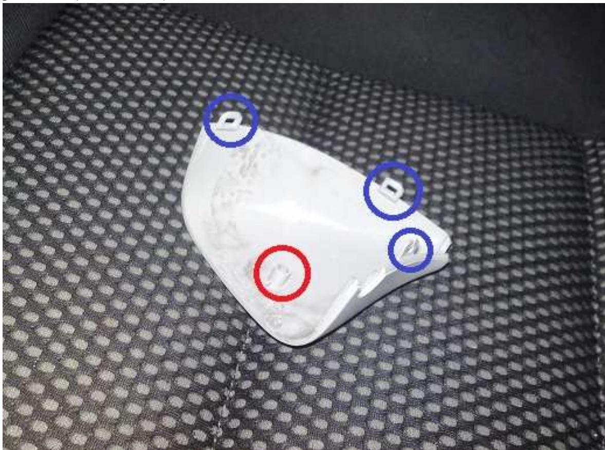
Nun hat man den Sensor in seiner Halterung und den Rückspiegel vor sich, diese werden getrennt indem man den Fuß vom Rückspiegel Richtung Armaturenbrett schiebt (die Führungsschiene ist rot markiert). Ruhig mit Kraft, der muss schließlich fest gehalten werden. Der Spiegel wird auf beiden Seiten mit der Metallklammer an der Windschutzscheibe gehalten.
