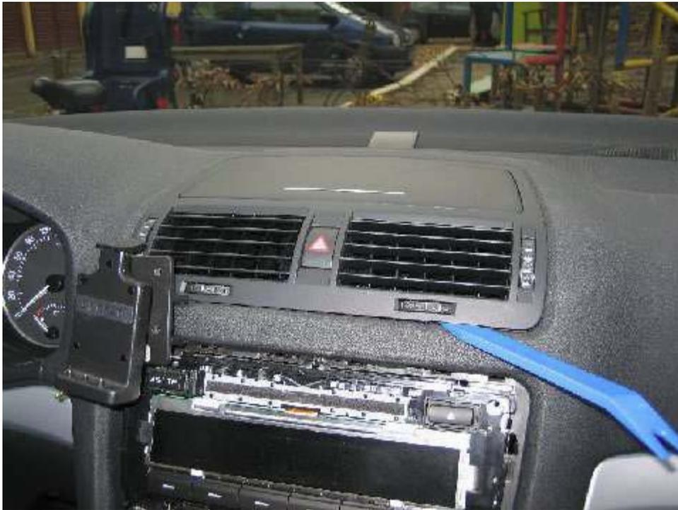
Es ist sehr wichtig das man das obere Ablagefach mit entfernt. Dann kann man von oben bis zum Radio runtergreifen.
