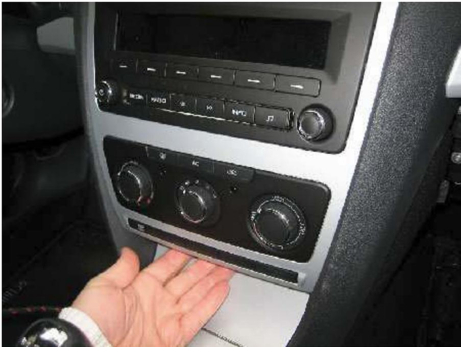
Als erstes wird die Verkleidung um Radio und Klimaanlage gelöst. Hierfür mit der Hand durch einen leichten Ruck die silberne Verkleidung lösen.
