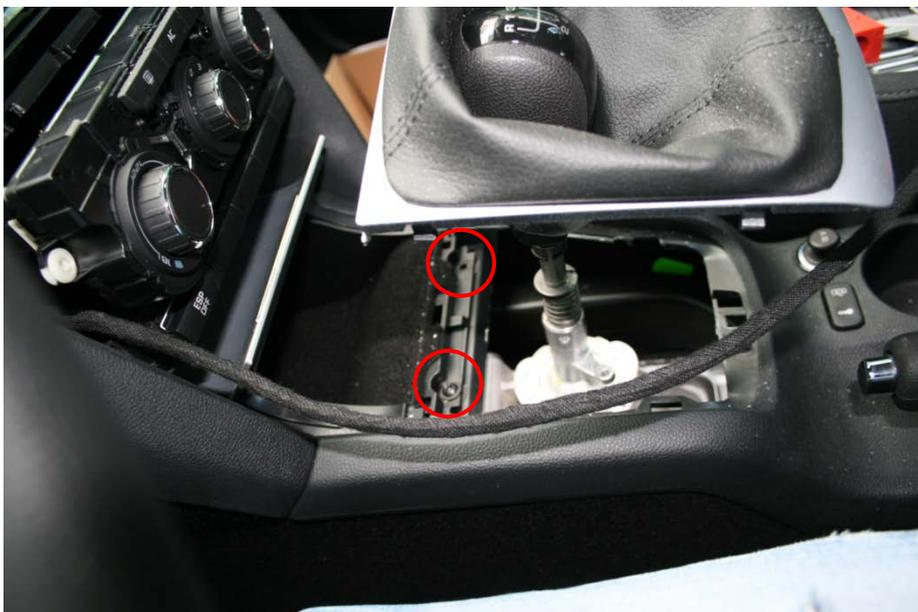
Um die Blende des Schaltknaufes zu lösen, einfach mit dem Keil an der Seite ansetzen und die Verkleidung hoch drücken. Weiterhin habe ich das untere Ablagefach entfernt. Die 2 Schrauben lösen und das Fach heraus ziehen.
