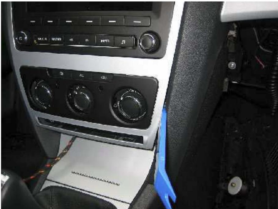
Danach langsam mit dem Kunststoffkeil die anderen Verriegelungen lösen und die Verkleidung entfernen.
