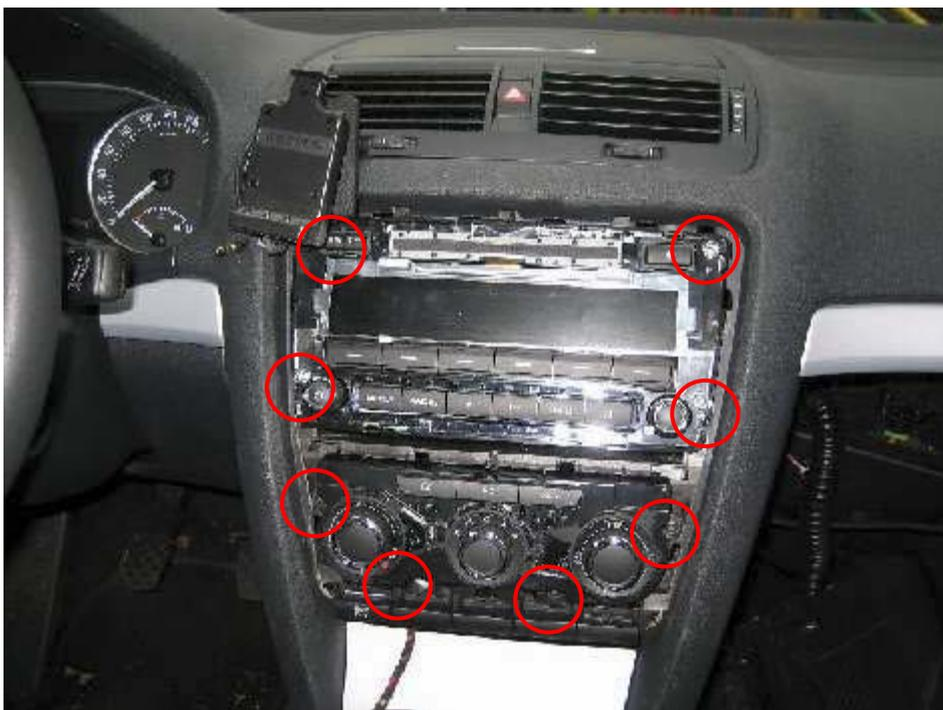
Die markierten Schrauben müssen mit dem Tx 20 gelöst werden. Danach kann das Radio und die Klimaeinheit (Climatic) nach vorn rausgenommen werden.
