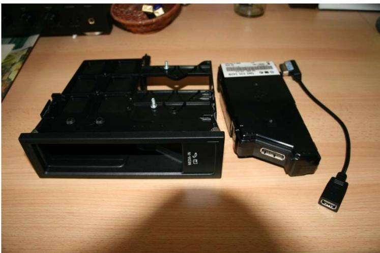
Entfernen des Media In Interfaces aus dem Media-In Einbaurahmen.
