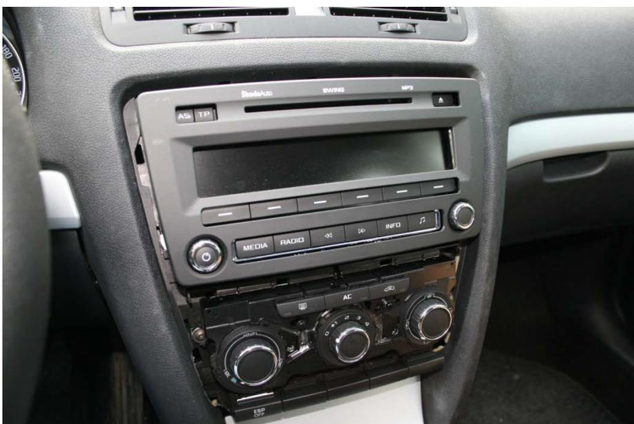
Jetzt wird die Blende des Radios entfernt. Einfach nach vorne abziehen.
