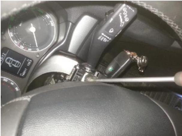
5. der Schalter befindet sich links vom Lenkrad unterhalb des Blinkerhebels das aufgeklebte Siegel aufschneiden und abziehen, einen kleinen Schlitzschraubendreher in den Schlitz stecken und den Deckel abnehmen
