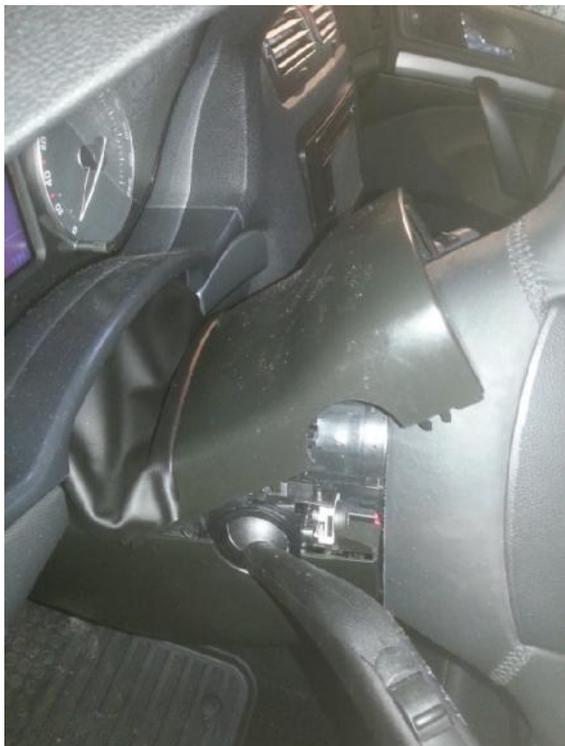
4. Lenkrad nach links und rechts drehen um die dahinterliegenden Schrauben herausdrehen zu können, Verkleidung nach unten abziehen und beim Hebel heraus fädeln dabei wird wahrscheinlich das Gummitteil beim Zündschloss herausfallen, das vor dem Einbau wieder richtig in die Verkleidung hineinschieben
