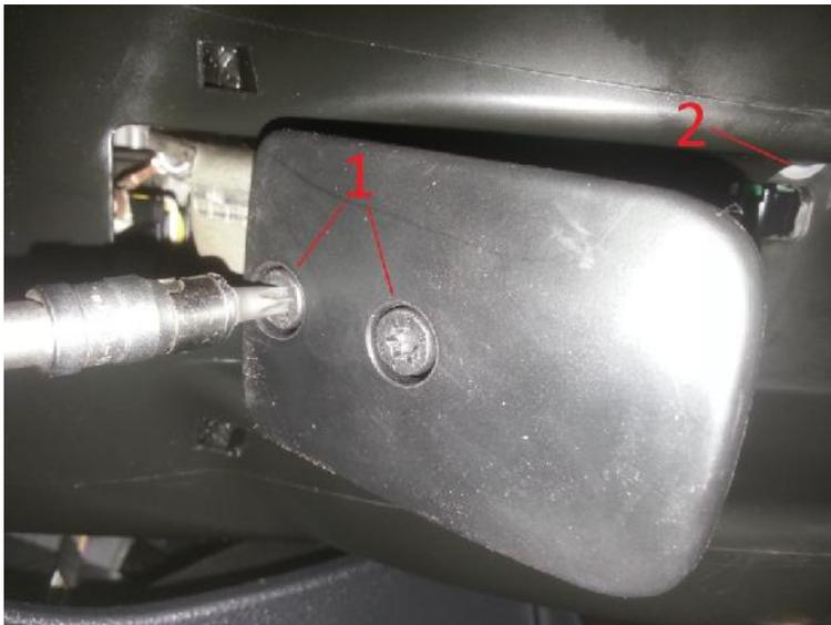
3. obere Hälfte der Lenksäulenverkleidung nach oben abziehen
