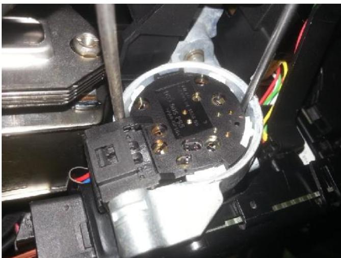
7. den neuen Schalter hineinschieben bis er einrastet, Stecker anstecken und Deckel einclipen in umgekehrter Reihenfolge alles wieder zusammenbauen
