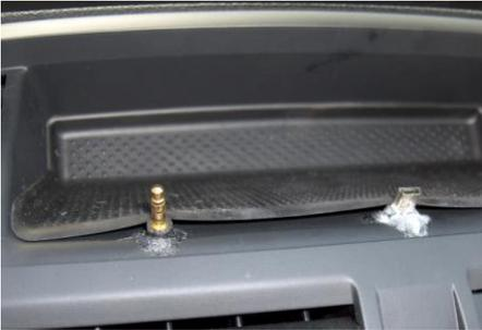
Ins ausgebaute (und vorübergehend vom Deckel befreite) Ablagefach wurden 2 Ausschnitte gebohrt/gefeilt, damit die beiden (ebenfalls etwas schlanker gemachten) Stecker senkrecht reinpassten. Die Lage der Löcher werden durchs Navi und die ‚Innereien‘ des Faches vorgegeben. Die Stecker habe ich mit Sekundenkleber und Füllmaterial verklebt. Das muss ich bei Gelegenheit noch nacharbeiten.
